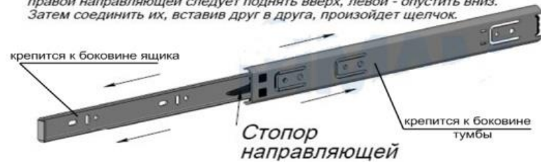
Рис.4 Схема установки шариковых направляющих
