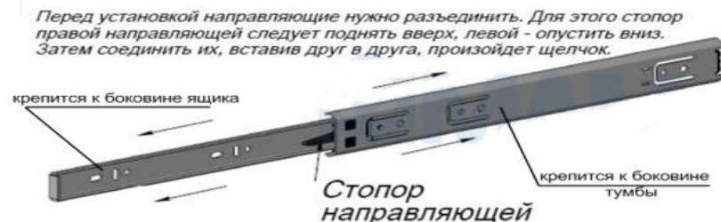
Рис.4 Схема установки шариковых направляющих
