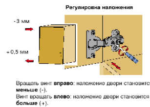
Рис.3 Схема регулировки петли
