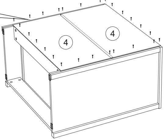
**8.** Соедините заднюю стенку ящика №7 с боковинами ящика №6 евровинтами, предварительно вставив дно ящика №8 в соответствующие пазы.
