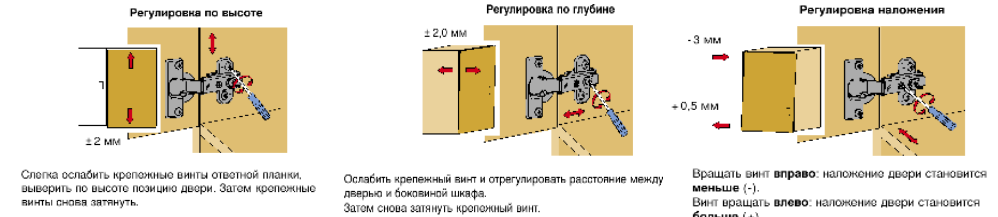
Рис.3 Схема установки петель
