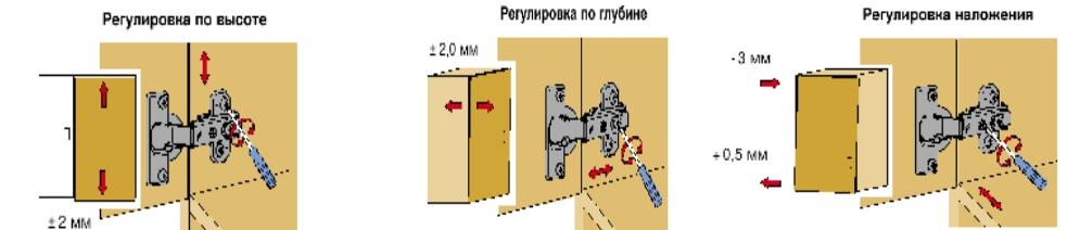
Слегка ослабить крепежные винты ответной планки, вывернуть по высоте позицию двери. Затем крепежные винты снова затянуть.
