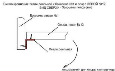
Рис.2 Схема крепления опор к боковинам стола на рояльные петли
